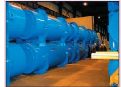
Entreposage des protections neutroniques
