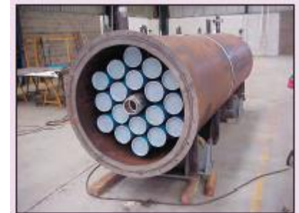
Colis contenant des protections neutroniques
